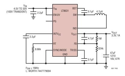
1MHz, 5V, 1A Step-Down Converter
